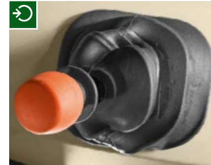
El freni asistanı otomatik konumda: El freni otomatik olarak etkinleştirilir.
