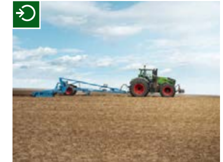
Traktör Yönetim Sistemi TMS ve otomatik Yük Sınır kontrolü 2.0 sayesinde traktör, sürüş hızına bağlı olarak motor devrini en ideal şekilde ayarlar.
