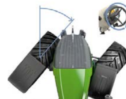
VarioActive ile sadece tek bir direksiyon turu ile tekerleğin tam dönüş açısı elde edilir.
